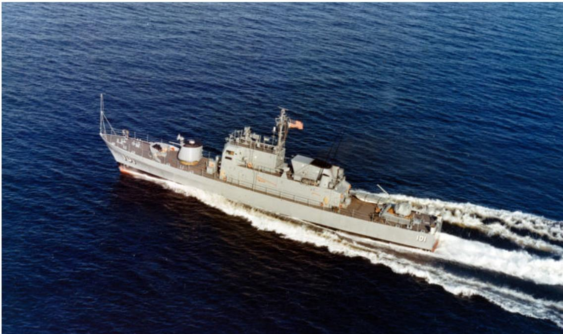
In den Jahren 1963 bis 66 wurden für die US-Navy 17 Schnellboote dieser Klasse gebaut. Sie waren größer als übliche Schnellboote, hatten einen Gasturbinen-Diesel-Antrieb und waren mit sehr verschiedener Bewaffnung bestückt. Es gab Typen mit 7,6-Automatik-Kanone, mit Tartar-Raketenanlage, mit Wabos und Minen. Zwei Boote, die PGM 86 und 87 hatten die HSA-M22 Feuerleit-anlage (Radom-Kugel). Die Boote, die im Küsteneinsatz vor Vietnam eingesetzt waren, hatten in dieser Zeit Tarnbemalungen.
