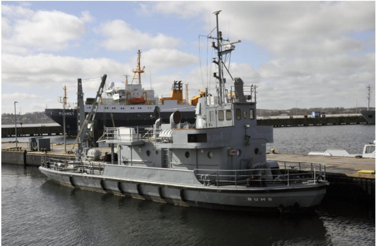
Mit einer leistungsstarken Druckluftanlage auf Basis eines Junkers Freikolbenverdichters kann BUNS die „Schockmodule“ kontrolliert versenken und wieder heben. Das sind spezielle U-Boot-Segmente, aber auch ganze U-Boote, die mit Sensoren und Sprengladungen ausgestattet sind. Soll das Objekt auftauchen, wird das Wasser in den Flutzellen des Schockmoduls mit der Druckluft der BUNS verdrängt – es wird „Angeblasen“.
