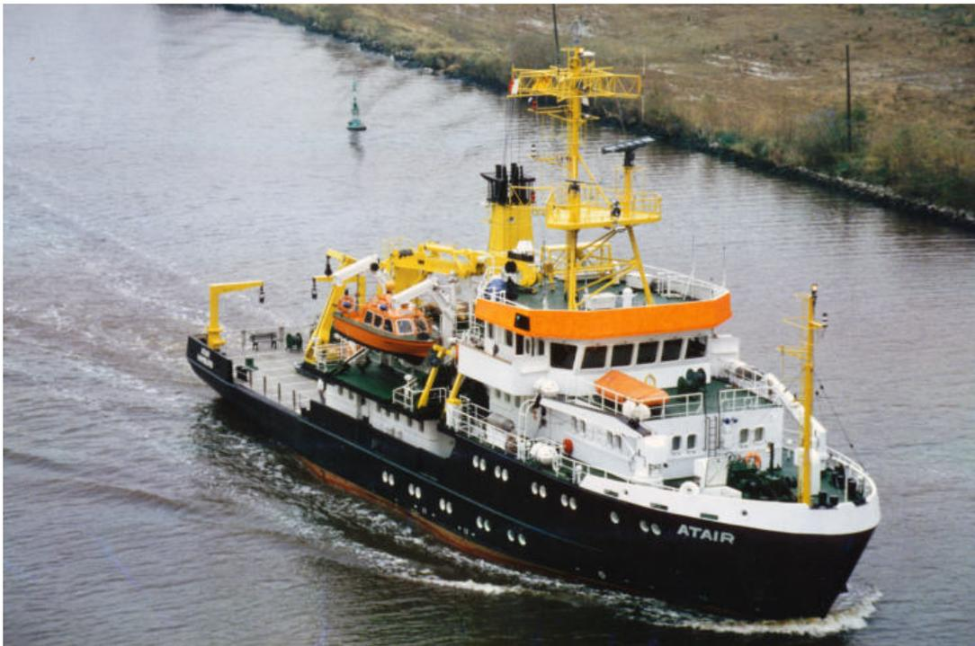
Am 3. August 1987 lieferte die Kröger-Werft dieses hochmoderne Vermessungs-, Wracksuch- und Forschungsschiff an das DHI ab. Das Schiff hat eine optimal gestaltete Vorschiffsform, ohne Bugwulst. Der flache Boden nimmt die zahlreichen Meßgeräte auf, ermöglicht aber auch ein Trockenfallen im Watt. Zur Positionierung besitzt die ATAIR einen SCHOTTEL-Pump-Jet. Mit diesem voll drehbaren Hilfsantrieb kann das Schiff bei Meßfahrten sogar 8 kn erreichen.
