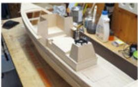
Die Aufbauten werden ebenfalls aus Holz gebaut. Hier zeigt sich exaktes Arbeiten aus
