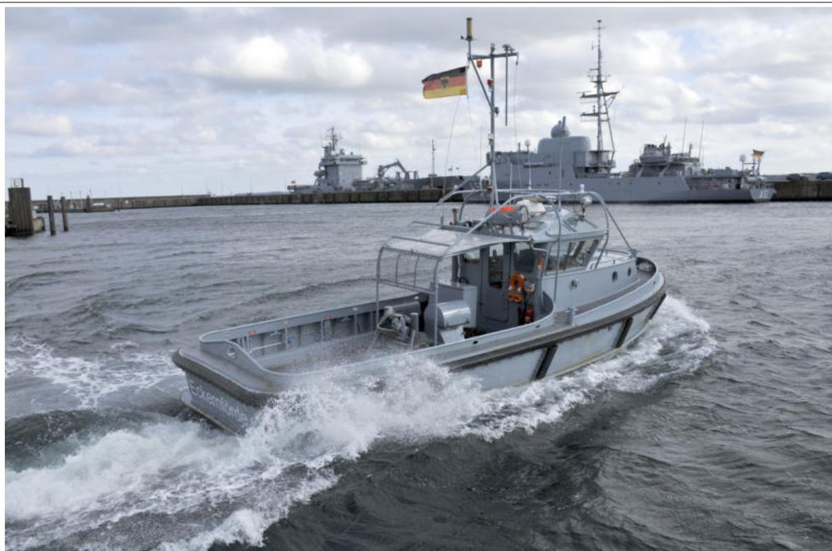
Die „AK1“ ist eine kleine Schleppbarkasse für die alltäglichen Aufgaben im Hafen. Sie ist ein wendiges Kraftpaket für schwere Arbeit und kann auf kleinstem Raum manövrieren. Ausgelegt ist sie für Verhol-, Schlepp- und Bugsierarbeiten, dem Transport von Gerät und Personal sowie dem Brechen dünner Eisdecken und dem Verschiften von Eisschlamm und Eisschollen.
